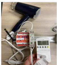
電流計測ゲートウェイ・ユニット
