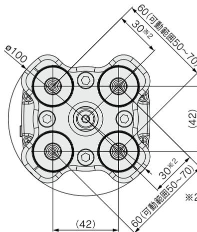
※2 可動範囲25~35(中央部にパッドを取付けた場合)パッド径によってはパッド同士が干渉しますので、ご使用ピッチに合わせたパッド径を選定願います。
