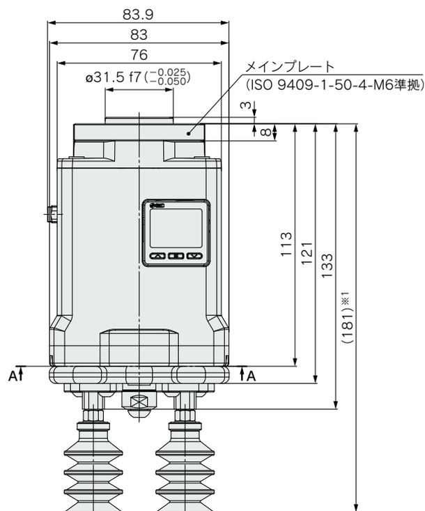
※1 本図の寸法は、パッド取付寸法例として品番: ZXPE5A011P-25JS-□Eの場合を示します。
