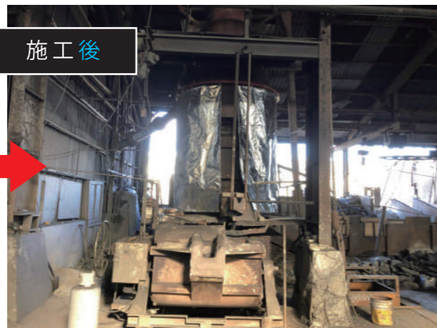
鉄を溶かすキューボラ (溶鉱炉)
