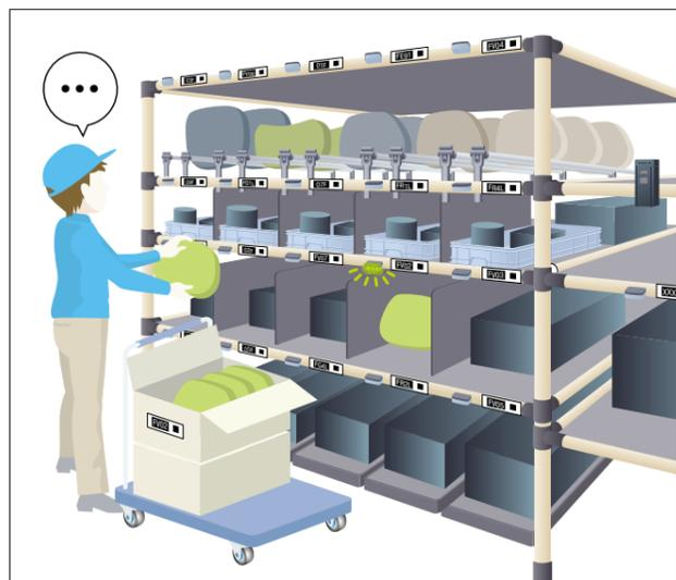
**After** 部品コードと投入間口を紐付ける事でシャッターを自動開閉。作業員はシャッターが開いた箇所に投入するだけ。
