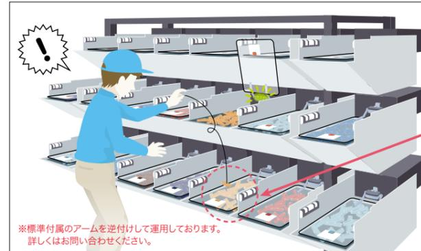
**After** 取出し間違い防止だけではなく、取りこぼし時の混入防止、シャッター開閉による次ピック箇所の発見速度UPで効率化にも役立ちます。
